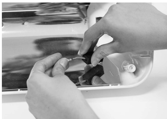
6. PODŁĄCZYĆ MĘSKIE ZACISKI (FASTON) NOWEJ RURKI DO ZACISKÓW OBU PRZEWODÓW ZASILAJĄCYCH, ZAKRYĆ JE OSŁONAMI I WŁOŻYĆ RURKĘ Z POWROTEM DO GNIADZA, ZABIJAJĄC JĄ W KLIPACH.
