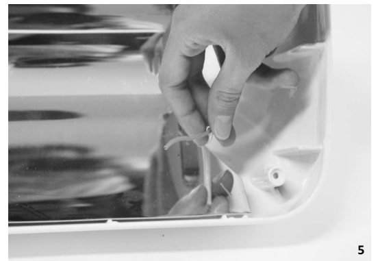
5. WŁOŻ ZAPASOWE KAPSUŁKI ELASTOTERMICZNE W MIEJSCE USUNIĘTYCH, ODIZOLUJ PRZEWODY NA DŁUGOŚĆ 5/6 mm, ZAŁOŻ NOWE ZAPASOWE ZACISKI FASTON I ZACISNIJ JE NA ODIZOLOWANEJ CZĘŚCI PRZEWODÓW. NALEŻY UWAŻAĆ, ABY NIE DOTYKAĆ ŻARÓWKI GOŁYMI RĘKAMI.
