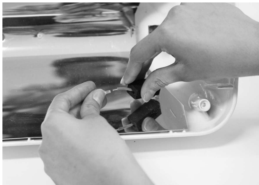
6. Podłączyć płaskie wtyki nowej żarówki do wtyków obu przewodów, założyć uszczelki i umieścić żarówkę w gnieździe obu sprężyn.
