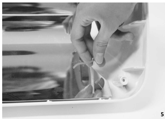
5. ZAŁÓŻ ZAPASOWE NASADKI TERMOELASTYCZNE, ABY ZASTĄPIĆ TE, KTÓRE ZOSTAŁY ZDEJĘTE. ODIZOLUJ PRZEWODY (5–6 mm). ZAŁÓŻ NOWE ZAPASOWE ZŁĄCZA FASTON I DOKŁADNIE JE DOCIŚNIJ DO ODIZOLOWANEJ CZĘŚCI PRZEWODÓW. NIE DOTYKAJ ŻARÓWKI GOŁYMI RĘKAMI.
