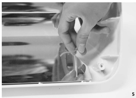
5. ZAŁOŻYĆ ZAPASOWE OSŁONY TERMOELASTYCZNE W MIEJSCU TYCH, KTÓRE ZOSTAŁY ZDJĘTE, A NASTĘPNIE ODIZOLOWAĆ PRZEWODY NA DŁUGOŚCI 5/6 MM. ZAŁOŻYĆ NOWE ZASTAWKOWE KOŃCÓWKI (FASTON) I ZACISNĄĆ JE NA ODIZOLOWANEJ CZĘŚCI PRZEWODÓW. NIE DOTYKAĆ ŻARÓWKI GOŁYMI RĘKAMI.
