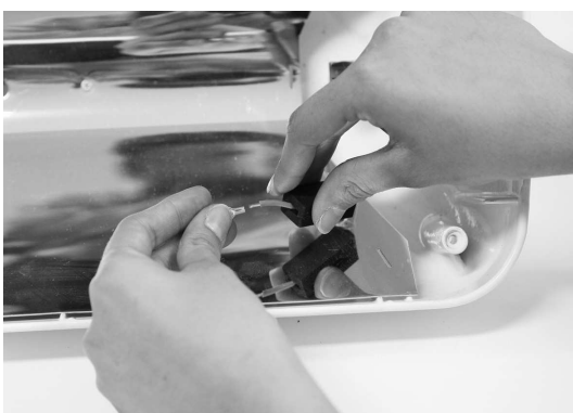
6. PODŁĄCZYĆ MĘSKIE ZŁĄCZA FASTON NOWEJ ŻARÓWKI Z ZŁĄCZAMI DWÓCH PRZEWODÓW, ZAŁOŻYĆ NA NIE KAPSUŁKI ELASTOTERMICZNE I PONOWNIE UMIEŚCIĆ ŻARÓWKĘ W GNIEZDZIE SPRĘŻYN.
