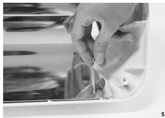
5. ZAŁOŻ ZAPASOWE KAPSUŁKI ELASTOTERMICZNE W MIEJSCU USUNIĘTYCH, ODIZOLUJ PRZEWODY NA DŁUGOŚĆ 5-6 mm, ZAŁOŻ NOWE ZAPASOWE ZŁĄCZA FASTON I WCIŚNIJ JE NA ODIZOLOWANĄ CZĘŚĆ PRZEWODÓW. NALEŻY UWAŻAĆ, ABY NIE DOTYKAĆ ŻARÓWKI GOŁYMI RĘKAMI.
