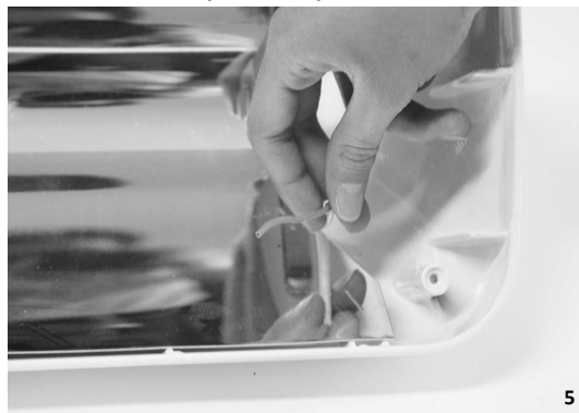
5. W PRZYPADKU ZUŻYCIA NALEŻY ZAŁOŻYĆ NOWE USZCZELKI, ODIZOLOWAĆ KABEL NA DŁUGOŚCI 5–6 mm, ZAŁOŻYĆ NOWE WTYKI PŁASKIE I PRZYMOCOWAĆ JE DO KABLA. ODIZOLOWAĆ KABEL NA DŁUGOŚCI 5–6 mm. ZAŁOŻYĆ NOWE WTYKI PŁASKIE I PRZYMOCOWAĆ JE DO KABLA. NIE DOTYKAĆ LAMPY GOŁYMI RĘKAMI.
