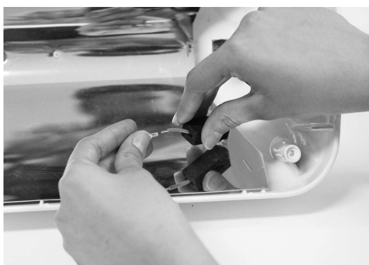
6. PODŁĄCZYĆ ZŁĄCZA MĘSKIE NOWEJ ŻARÓWKI DO ZŁĄCZ DWÓCH PRZEWODÓW, ZAŁOŻYĆ NA NIE KAPSUŁKI ELASTOTERMICZNE I UMIEŚCIĆ ŻARÓWKĘ Z POWROTEM W GNIADZIE
