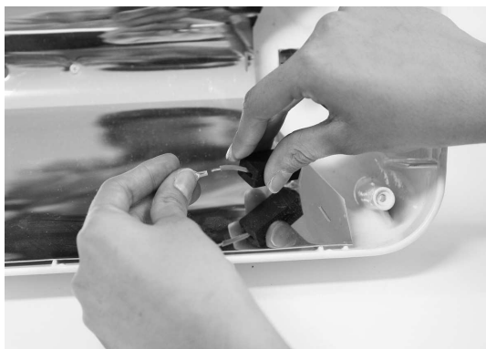
6. PODŁĄCZYĆ MĘSKIE ZŁĄCZA FASTON NOWEJ ŻARÓWKI DO ZŁĄCZ DWÓCH PRZEWODÓW. ZAKRYĆ JE OSŁONAMI TERMOELASTYCZNYMI I PONOWNIE UMIEŚCIĆ ŻARÓWKĘ W GNIEZDZIE SPRĘŻYNOWYCH ZACISKÓW.
